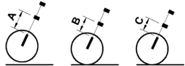
S2.1 - Durchhang Messungen Vorderseite
